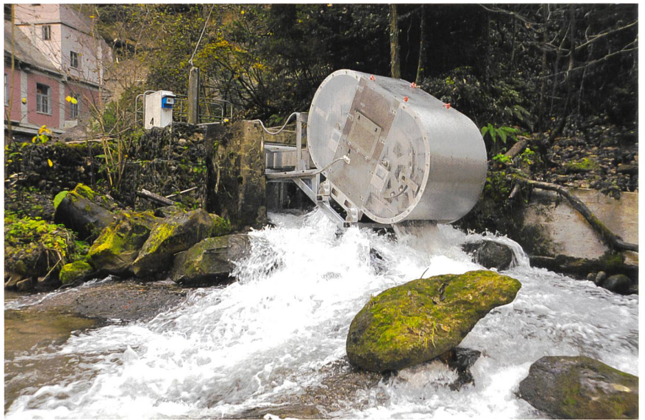
Bild 1. Die Steffturbine ist eine Kleinturbine für die Nutzung von Wasserkraft in kleinräumigem Gelände. Im Bild der Prototyp beim Kleinwasserkraftwerk Pilgersteg in Rüti (Zürich).
