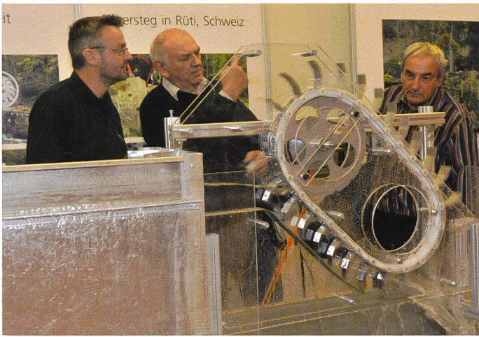
Bild 2. Am Modell werden die strömungsbedingten Einflüsse auf den Wirkungsgrad der Steffturbine untersucht.
