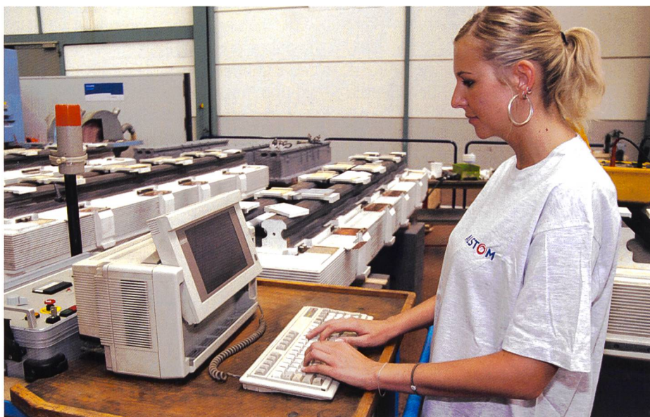
Bild 2. Elektrische Abnahmeprüfungen an Polen im Werk Birr.
