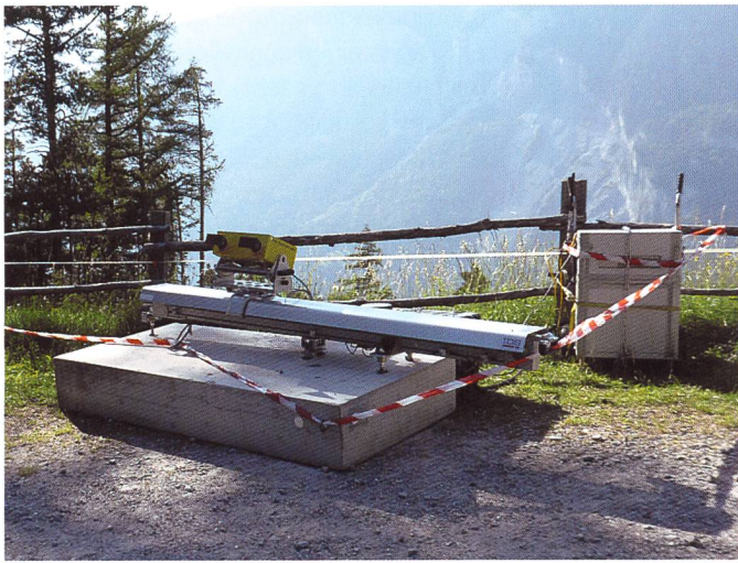
Bild 8. Einfache Montage auf einem Betonsockel für die temporären Messungen in Domat-Ems.
