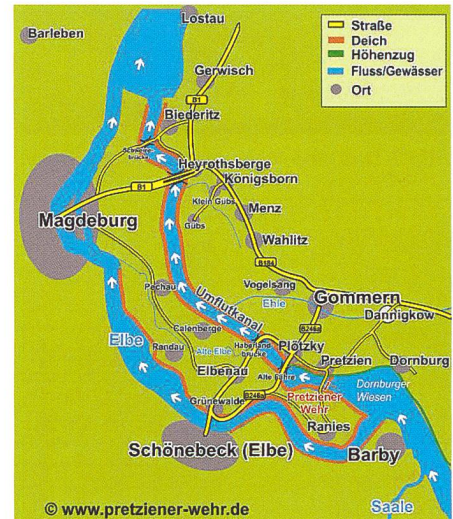
Bild 2. Das bei Hochwasser geöffnete Pretziener Wehr – mit Umleitung eines Teils des Elbwassers durch den Umflutkanal – an Schönebeck und Magdeburg vorbei.
