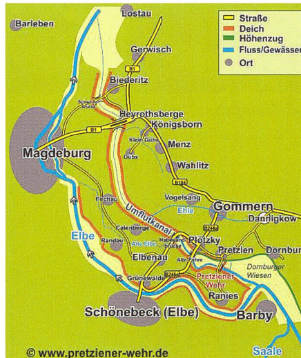
Bild 1. Anordnung des Pretziener Wehrs an der Elbe mit Umflutkanal und dem Leitpegel Barby.
