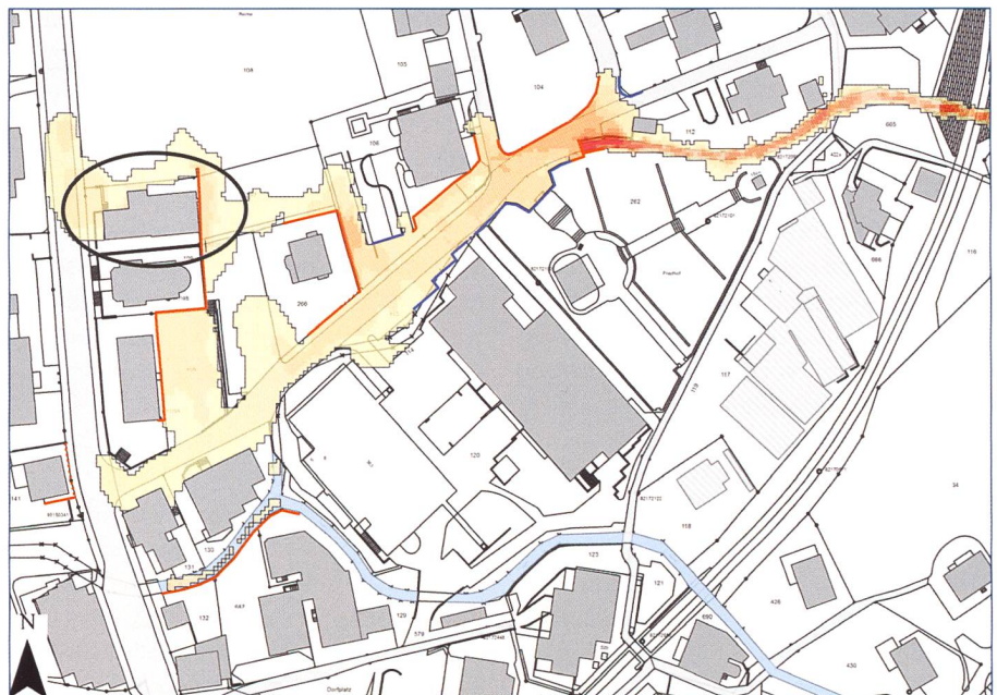
Bild 5a. Fliesstiefen für ein Ereignis aus dem Gebiet Glinge. Die erste Variante der Objektschutzmassnahmen führt zu erhöhten Fliesstiefen am Gebäude in der Markierung.
