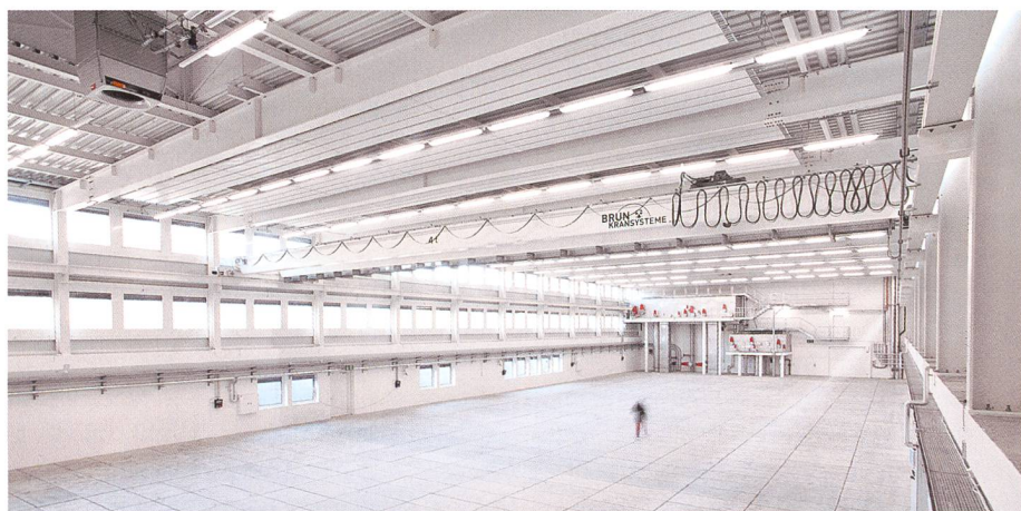
Bild 2. Versuchshalle kurz nach Fertigstellung; im Hintergrund die Hochbehälter der getrennten Klar- und Trübwasserkreisläufe.
