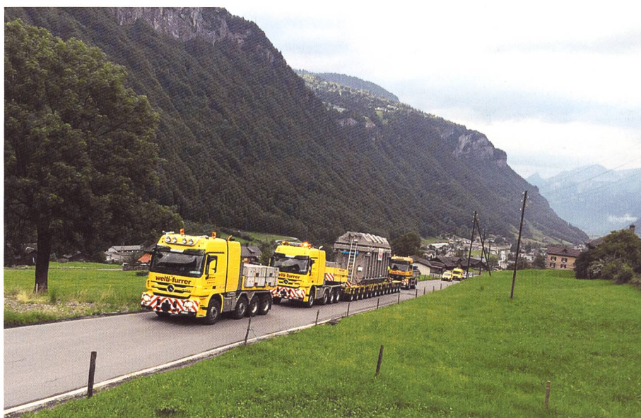
Bild 4. Transport des Transformators mit drei Zugfahrzeugen durchs Linthal (Foto: ABB).
