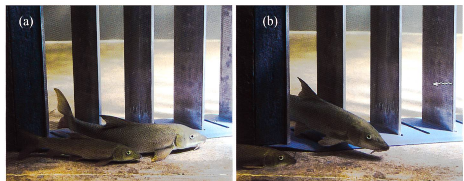
Bild 8. Barben im Versuch mit modifiziertem Bar-Rack ( \alpha = 15^\circ und B = 12 cm) und permanentem Kontakt zum Leitrechen bei U_0 = 0.6 m/s (Foto: D. Flügel).
