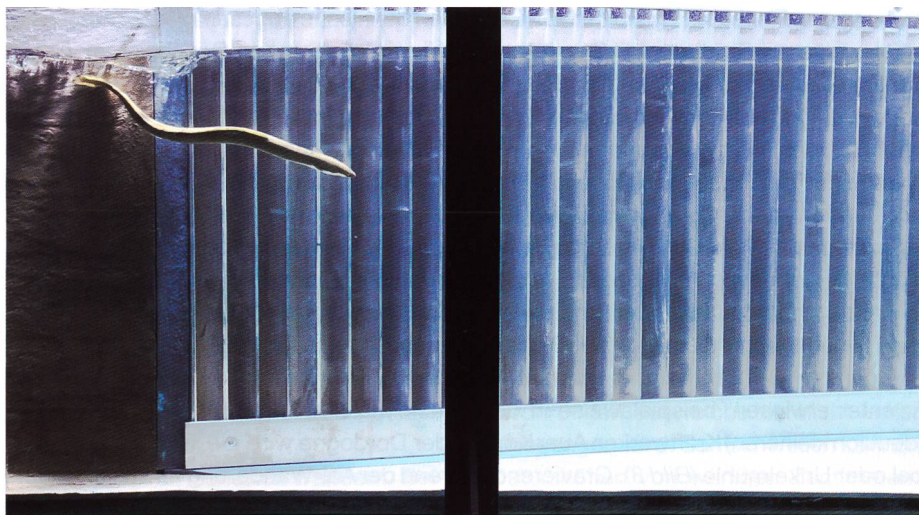
Bild 5. Aal vor der Leiteinrichtung im Modell an der VAW-ETHZ (Foto: David Flügel).
