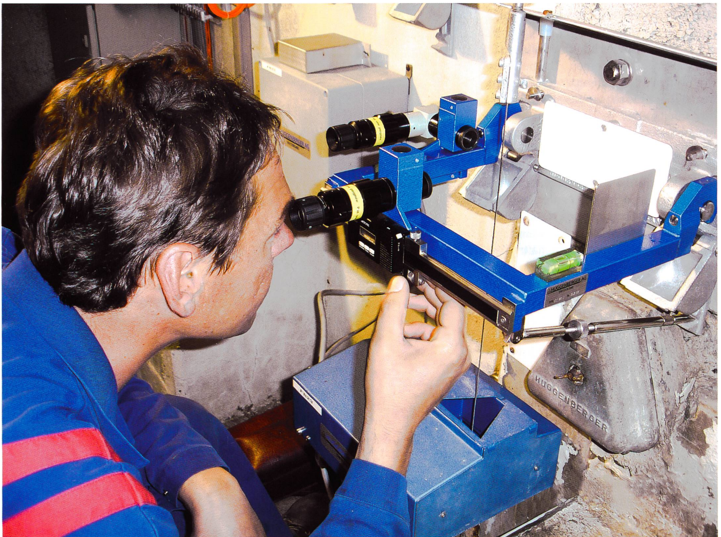
Barragiste en train de faire une mesure de pendule. / Dam warden taking a plumb line measurement.
