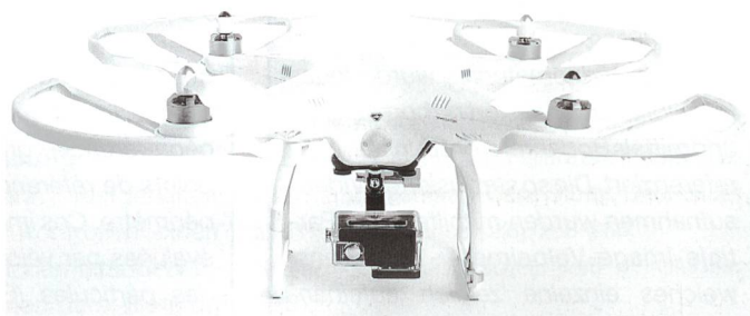
Bild 2. Quadrocopter DJI Phantom FC40 mit montierter 4K-Kamera GoPro Hero3+ Black-Edition (Orientierungsrichtung zum Boden, inkl. wasserdichtem Schutzgehäuse).
