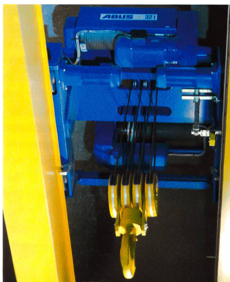
Bild 4. Die ABUS-Laufkatze mit einer Hubleistung von 2.4/15.1 kW und einer Fahrleistung von 2 x 0.14 / 0.65 kW ist zweistufig polschaltbar 5/20 m/min.
