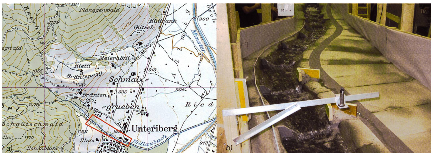
Bild 3. Links: Rot markierter Modellperimeter, rechts: Ausleitstrecke mit Leitspornen.
