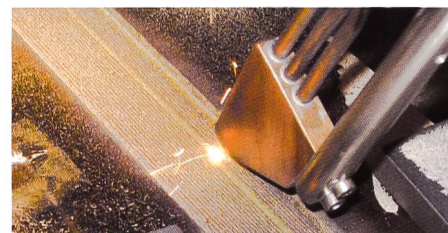
Bild 5. Flächiges Auftragsschweissen mit einer Off-Axis-Düse.
