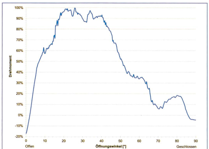
Diagramm 9. Drehmomentverlauf am Drehkörper beim Schliessen im Rohrbruchfall.
