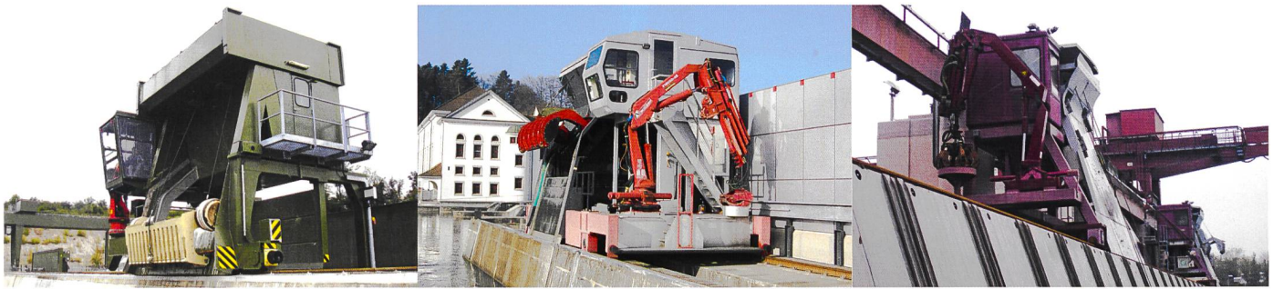
Bild 3. Vergleich zwischen einer ungünstigen (links, Baujahr 2009) und zwei gut konstruierten Maschinenvorderseiten (Mitte Baujahr 1995 und rechts Baujahr 1991) in Bezug auf die Gebrauchstauglichkeit.
