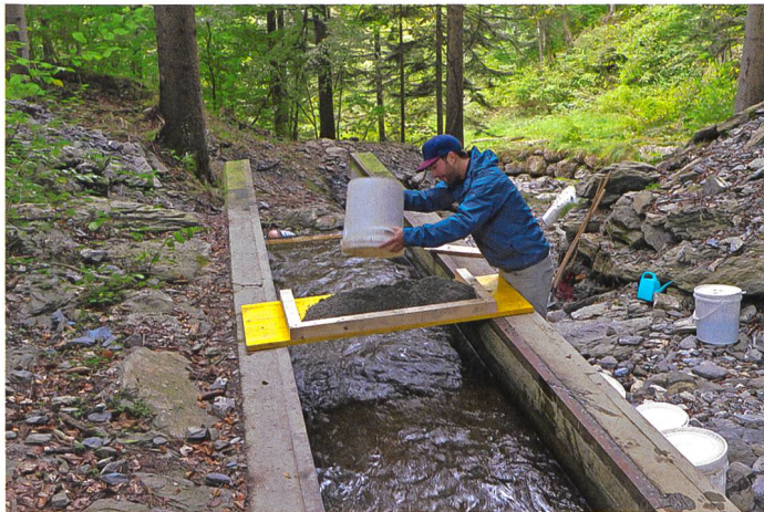
Bild 8. Bauingenieur Sascha Dosch, wissenschaftlicher Mitarbeiter im IBAR, präpariert den Feldversuch am Mühlbach: Er platziert auf einem Brett die Sand-Kies-Mischung, die später in den Fluss gekippt wird, um anschliessend zu messen, welcher Teil der Mischung durch den Coanda-Rechen – er befindet sich am Ende des Betonkanals – zurückgehalten wird.
