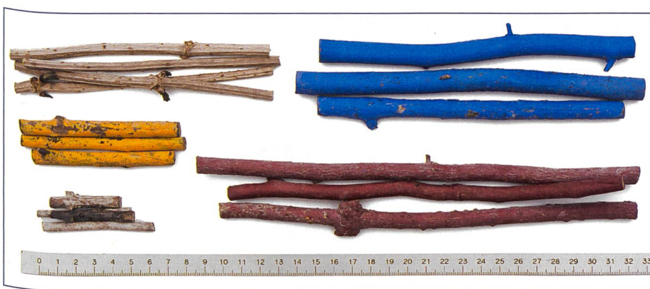
Bild 4. Modellschwemmholz in 5 Klassen (Massstab 1:40).
