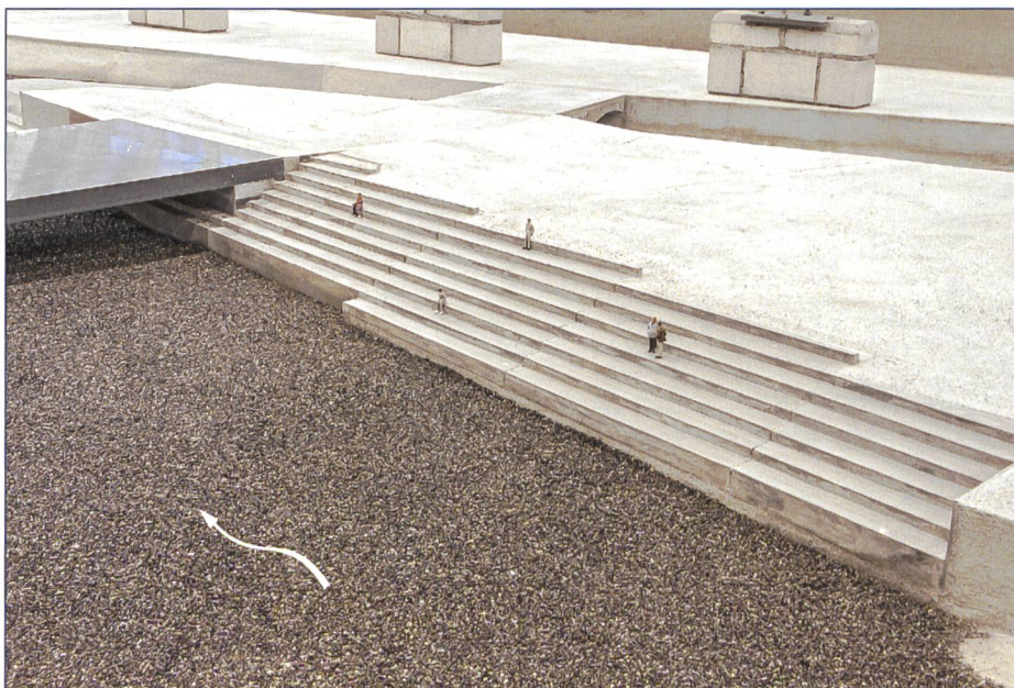
Bild 12. Sitzstufen bei Sigi-Feigel-Terrasse im hydraulischen Modell (Massstab 1:30).
