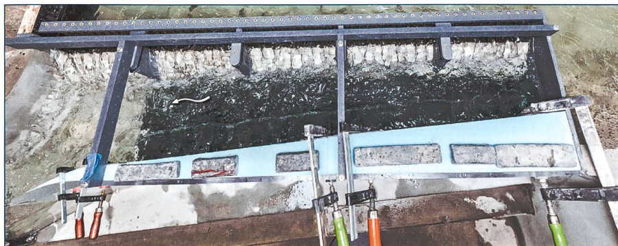
Bild 15. Strömungsbild in der Sammelrinne mit Rotationsströmung und Luftschlauch im Wirbelkern während des Spitzenabflusses des HQ 300 .
