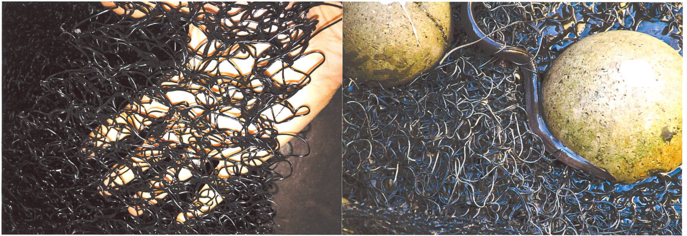
Bild 2: Links: Wirrgelegematte vor dem Einbau (Foto: M. Mende), rechts: Steigaal auf Wirrgelegematte in trockengelegtem RBP (Foto: Hersteller).
