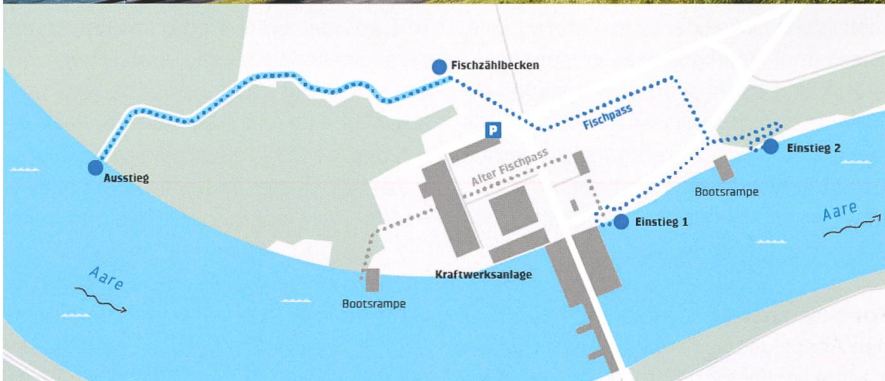
Geplanter Fischpass am Kraftwerk Bannwil (Bild: BKW).
