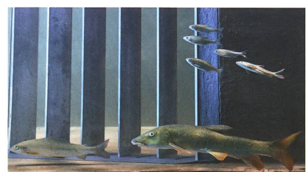
Bild 10: Barben (unten) und Schneider (oben rechts) schwimmen an einem Fischleitrechen im Labor (Foto: VAW).
