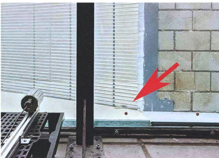
Bild 3: Eine Kamera erfasst im VAW-Labor an der ETH Zürich das Verhalten von Fischen am Leitrechen. Rechts unten am Rechen (mit Pfeil markiert) ist eine Barbe zu sehen, die gegen das von links anströmende Wasser schwimmt und durch die horizontalen Stäbe des Rechens zu schlüpfen droht (Foto: VAW).
