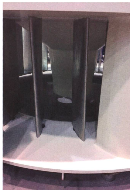
Bild 12: Ideale Ausrichtung der Stütz- und Leitschaufeln der Turbine (Foto: Groupe E).
