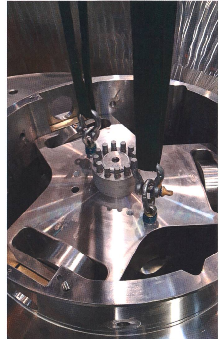
Bild 13: Verstellmechanismus des Kaplan-Laufrades (Foto: Groupe E).
