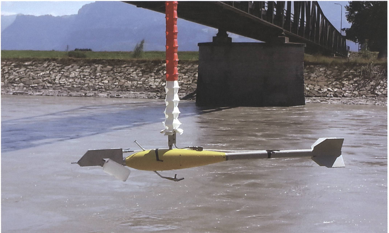
Bild 1: Vorrichtung zur Entnahme von Schwebstoffproben.
