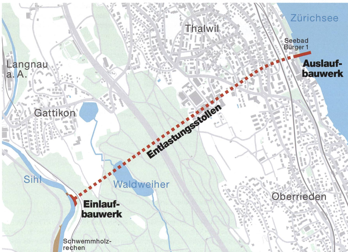
Bild 3: Der geplante Einlauf des Entlastungsstollens befindet sich an der Sihl oberhalb von Langnau a. A., direkt unterhalb des neuen Schwemmholtzrechens. Im Bereich des Seebads Bürger 1 in Thalwil soll er in den Zürichsee münden.
