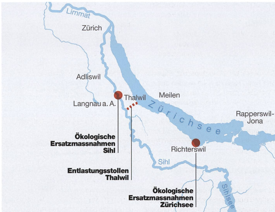
Bild 2: Zum Schutz des unteren Sihltals und der Stadt Zürich sollen mit dem Entlastungsstollen Hochwasserspitzen der Sihl in den Zürichsee umgeleitet werden. Die gesetzlich vorgeschriebenen ökologischen Ersatzmassnahmen sind im Sihltal und am Zürichsee in Richterswil vorgesehen.
