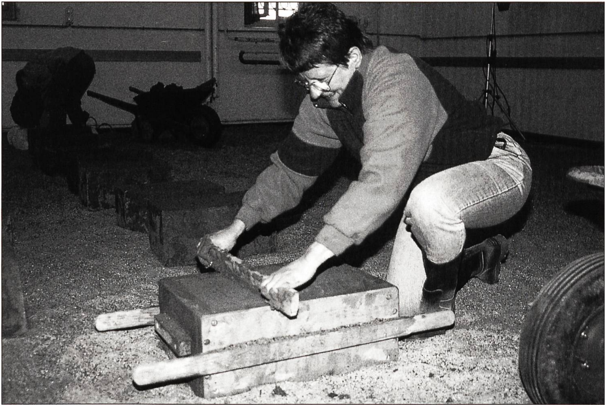
Abbildung 7: Den überschüssigen Lehm entlang der Oberkante der Form zieht Gisela Wimpff mit einem Brett ab.
