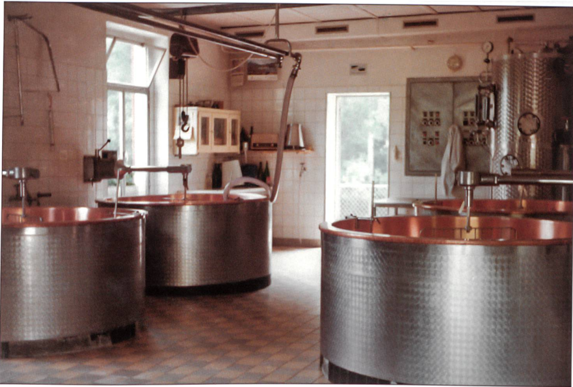
Käserei Hofstetten, Willisau, 1968–1987: Käseküche mit vier Käsekessi, Dampfkessel im Hintergrund (Dampferzeugung mit Heizöl). Foto Pius Oggier
