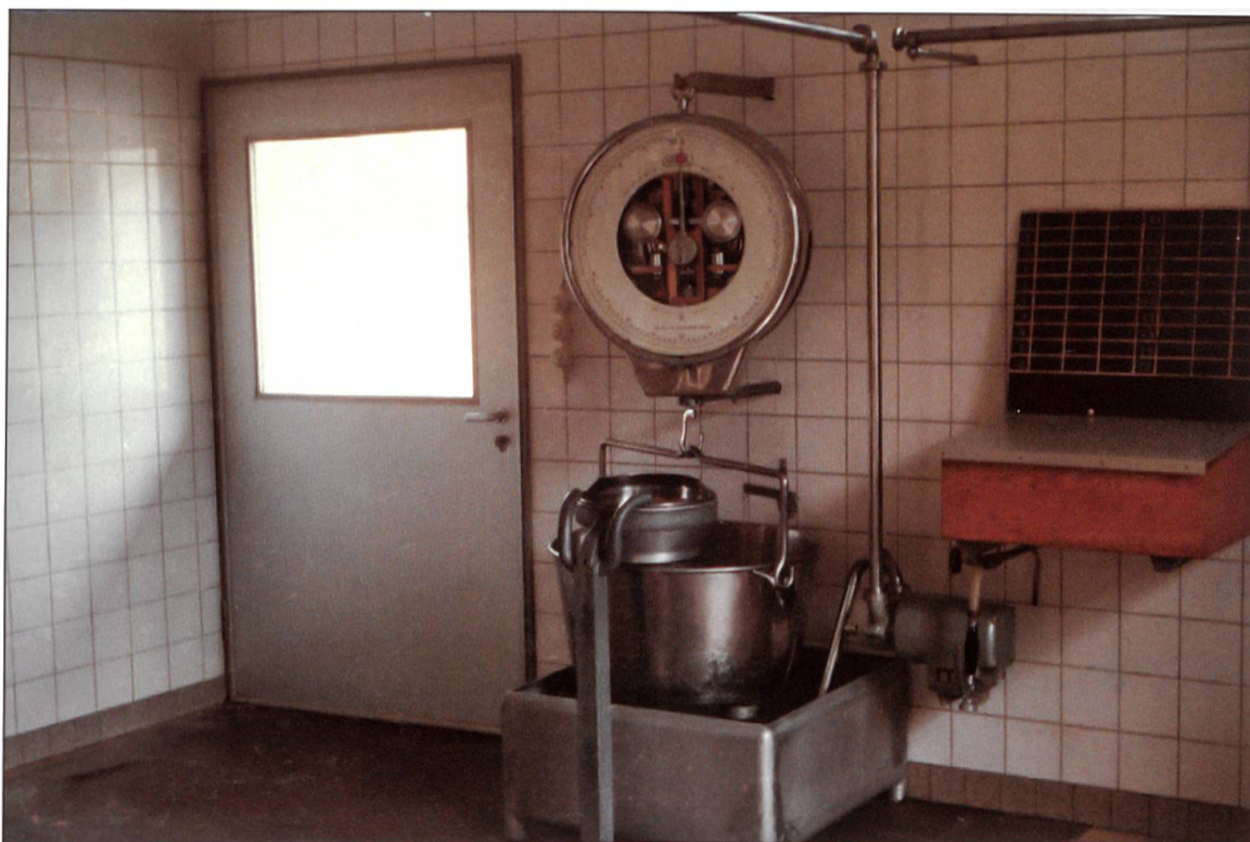
Käserei Hofstetten, Willisau, 1968–1987: Waage mit Kessel/Milchbassin und automatischer Förderung (Pumpen) ins Käsekessi. Foto Pius Oggier
