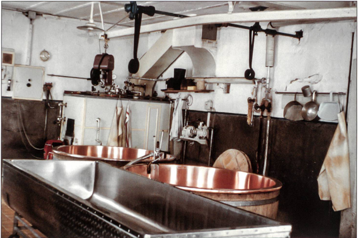
Käserei Hofstetten, Willisau, 1960: Käseküche mit zwei Käsekessi, Dampfkessel im Hintergrund (Dampferzeugung mit Kohle).
