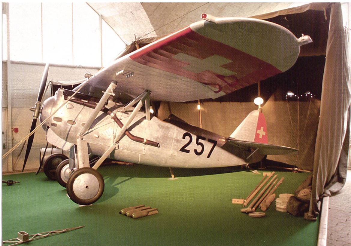
Dewoitine, D27, von Emil Dewoitine 1927 entworfen und in Frankreich gebaut. In der Schweiz weiterentwickelt (Flugzeugwerke Emmen). Antrieb: Hispano-Suiza HS-12Mc, V12-Zylinder mit 500 PS. Foto Flugzeugmuseum Dübendorf
