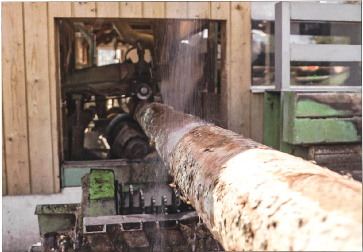
Schälen von Rundholz zur Herstellung von Masten.
