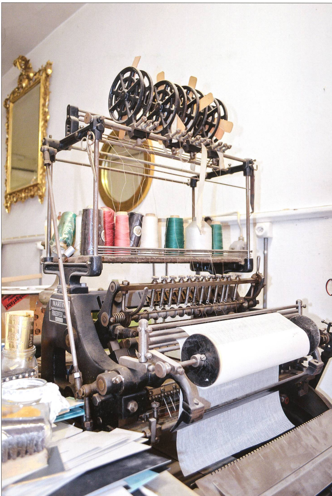
Bewährt sich seit vielen Jahren: die Fadenheftmaschine für das Nähen von Büchern.
