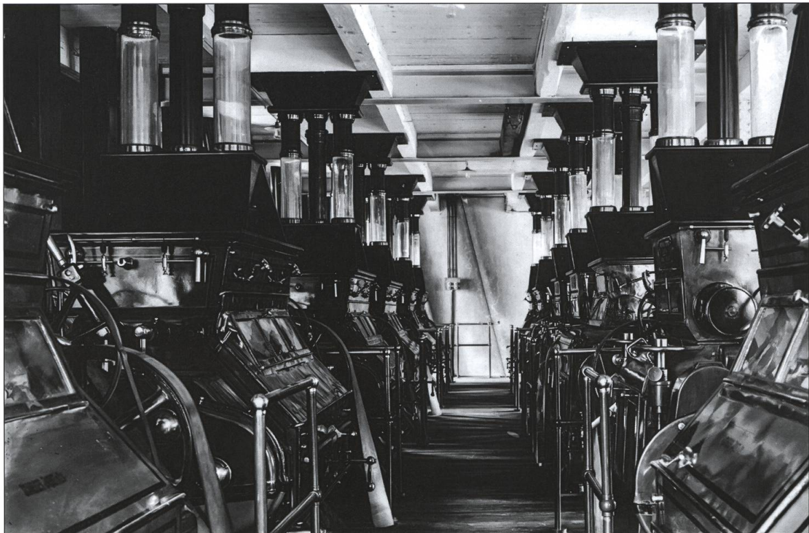
Walzenstühle: Die Erfindung des Walzenstuhles nach Mitte des 20. Jahrhunderts war zweifellos eine bahnbrechende Erneuerung des Mahlverfahrens. Die Mühle in Alberswil soll, so Fachleute aus dem Büro für Industriekultur aus Winterthur, die erste Anlage unseres Landes sein. Johann Jakob Sulzenbach aus Frauenfeld wird als Schöpfer dieses neuen Mahlsystems bezeichnet. Dank dieser revolutionären Erneuerung konnten die Getreideverarbeitung stark beschleunigt und die Qualität des Mehls massgeblich verbessert werden.
