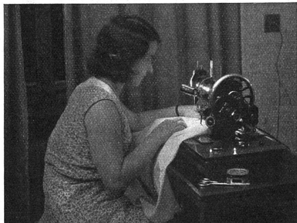
Der kleine Nähmaschinen-Reflektor spendet blendungsfreies Licht. Wenn mehrere Stunden bei künstlichem Licht genäht werden muss, empfiehlt sich die Anschaffung einer Leuchte, die angeschraubt oder an der nächstliegenden Wand montiert werden kann, da das heisswerdende Metall des kleinen Reflektors stören wird.
