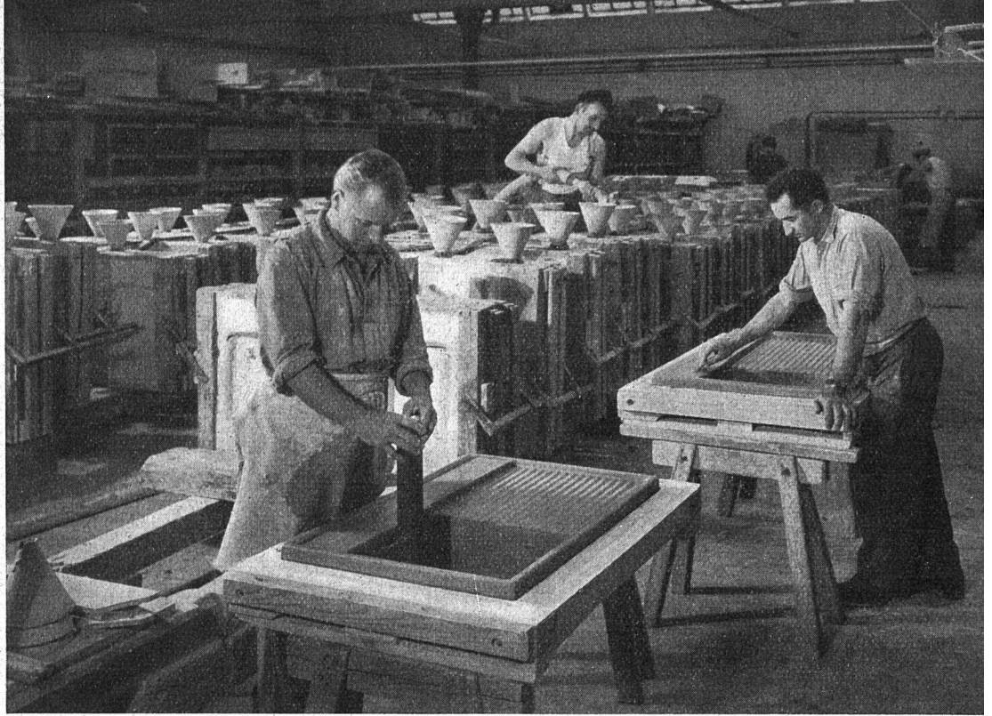
Die Apparate erhalten ihre Form durch das Ausgießen von Hohlformen aus Gips. Im Vordergrund unser Schüttstein «Linth».
