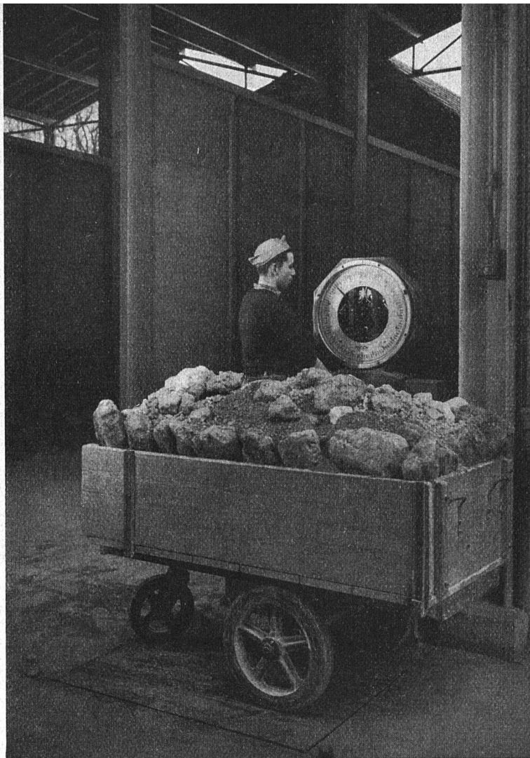
Die Rohstoffe werden gewogen, damit sie nach einem bestimmten Verhältnis gemischt werden können.
