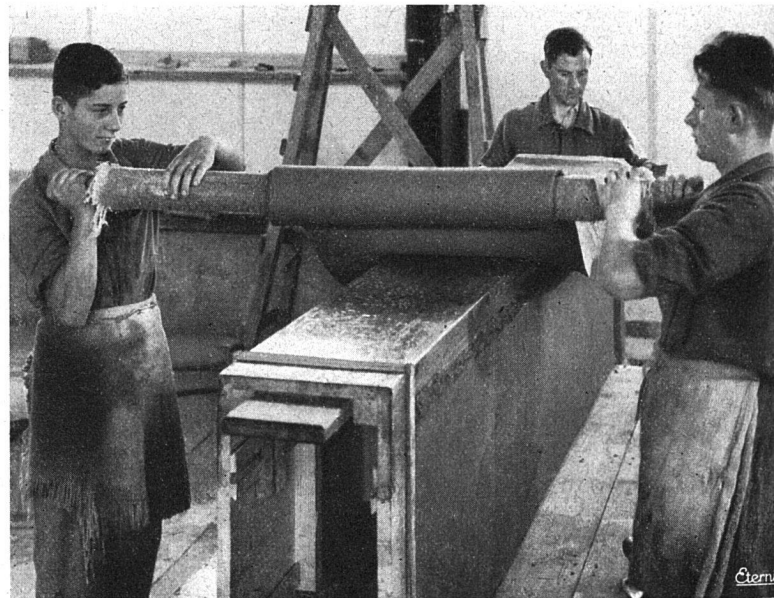
Abb. 12 Das zweite Plattenstück wird aufgelegt und angeformt
