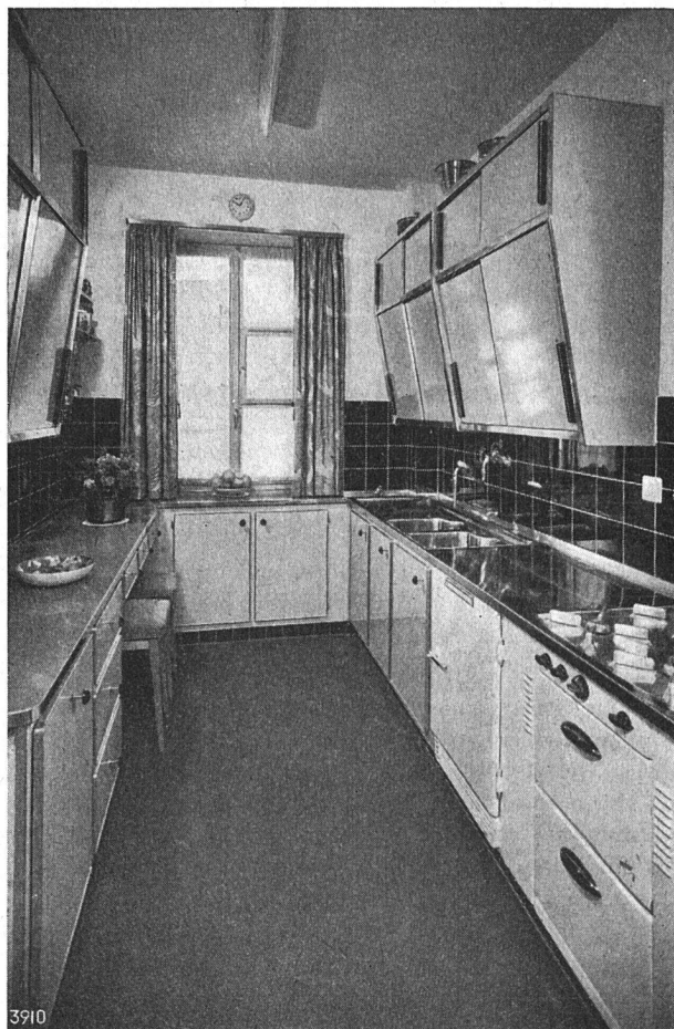
Bei dieser Gasküche sind die Arbeitsplätze in II-Form gruppiert. Der Küchenraum ist sehr gut ausgenützt, wobei ihm die farbige Kachelung eine wohnliche Note verleiht. Photo: A. Löhndorf, Basel
