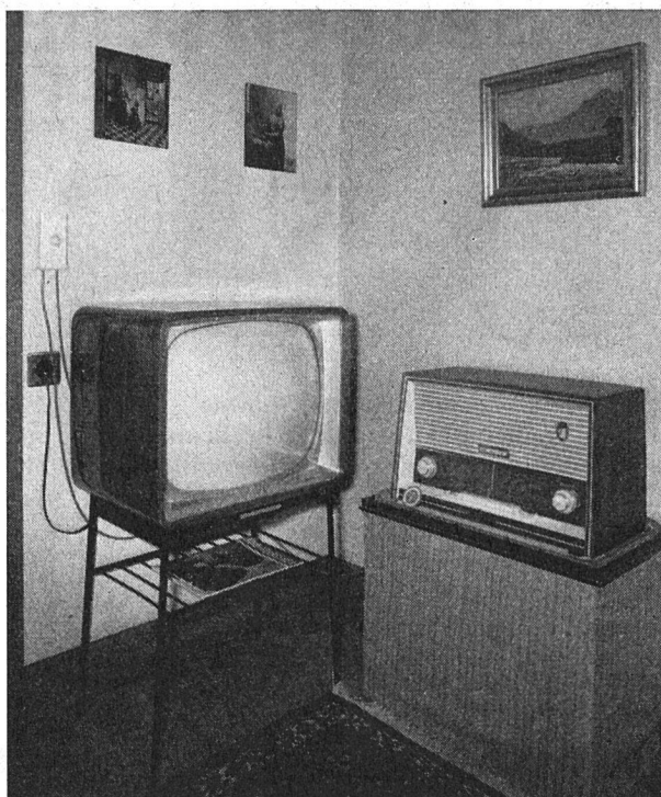
Beispiel eines kombinierten Abonnementanschlusses für Drahtfernsehen und Hochfrequenz-Drahttrundspruch. Die Auswahl der Programme geschieht beim Drahtfernsehen durch Drehen des Schaltknopfes der Wähldose an der Wand, beim Hochfrequenz-Drahttrundspruch durch Abstimmung am Empfänger selbst.
