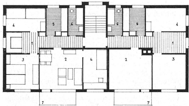
Wohngeschoß Block A (Viereinhalb- und Dreieinhalbzimmerwohnungen) 1 Wohnküche 2 Wohnzimmer 3 Schlafzimmer 4 Kinderzimmer 5 Küche 6 Bad 7 Balkon
