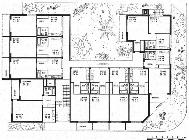
Wohnungen für Betagte in Zürich 9. Erdgeschossgrundriss. Bauherrschaft: Baugenossenschaft «Sonnengarten», Zürich. Architekten: A. F. Sauter & A. Dirlir, dipl. Architekten SIA, Zürich. Dreigeschossiger, U-förmiger Laubengangtyp mit insgesamt 30 Wohnungen: 24 Einzimmer- und 6 Zweizimmerwohnungen.
