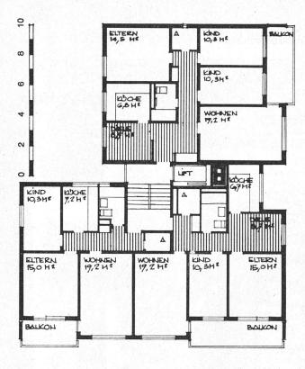
nen, Massivdecken konventionell an Ort und Stelle erstellt, Treppenläufe, Stürze, Fenster- und Balkonbrüstungen vorfabriziert und versetzt. Auf das Umfassungsmauerwerk wird innen eine 3 cm starke Sagexplatte aufgezogen und eine 4 cm starke tapezierfertige Seccopanplatte vorgemauert. Die Fenster werden in einer Holz-Metall-Konstruktion ausgeführt und mit geräuscharmen Leichtmetallrolladen versehen.
