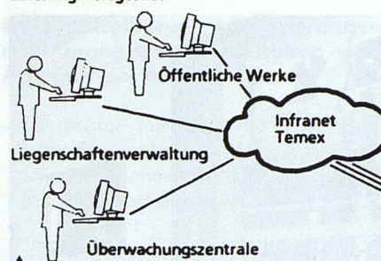
Leitwarten für Zählerfernablesung/Télégestion
