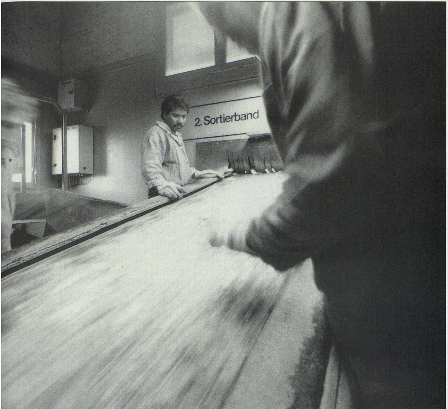
Jährlich geben Schweizerinnen und Schweizer über 230 000 Tonnen Altglas in den Kreislauf der Glasaufbereitung. Im 2-Schicht-Betrieb wird das Bruchglas von Fremdstoffen wie Kleidern, Regenschirmen, Öflaschen und Keramikteilen getrennt.
