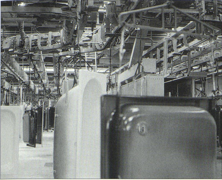
Automatisierte Transportanlagen und Spritzroboter übernehmen die harte Arbeit.
