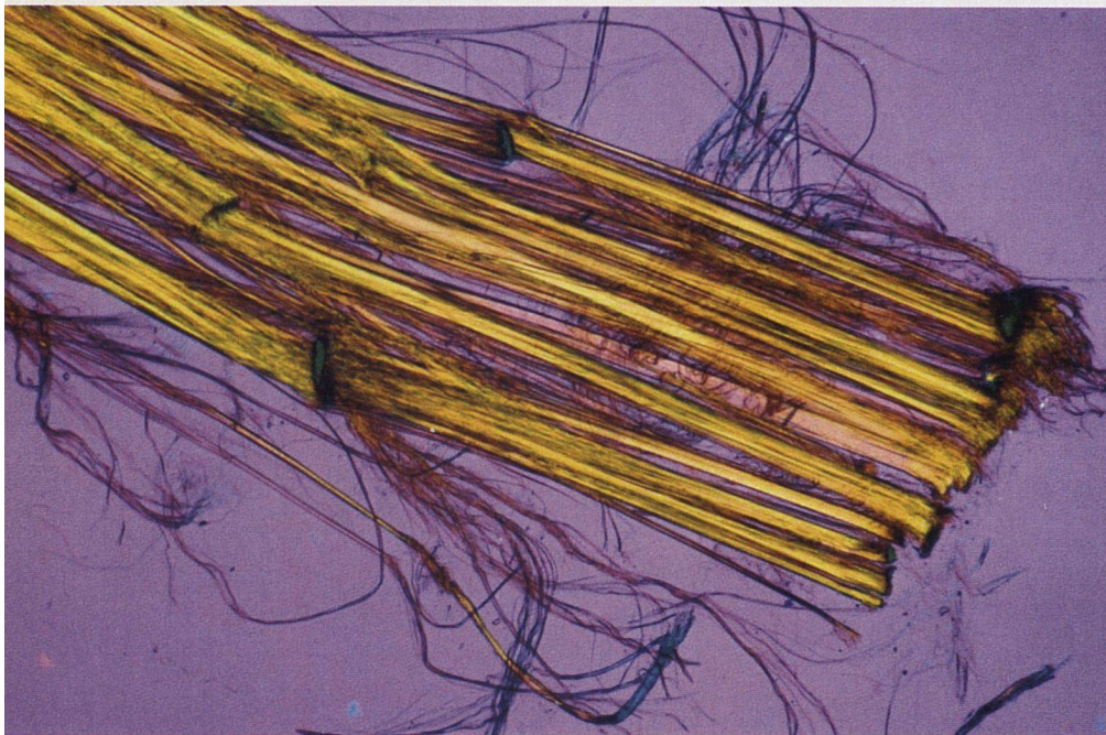
Chrysotil, der häufigste Asbesttyp, im Polarisationslichtmikroskop. Ersichtlich sind die feinsten, flexiblen Faserbündel und Fibrillen.
