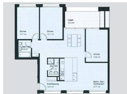
Grundriss einer Viereinhalbzimmerwohnung mit 115 Quadratmetern Wohnfläche.
