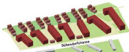
Verschiedene Volumenstudien zeigen die Möglichkeiten eines Ersatzneubaus der Siedlung Mattenhof. Links der heutige Mattenhof, der mit seinen zweigeschossigen Reihenhäusern eine sehr geringe Dichte aufweist, rechts ein mögliches Ersatzprojekt mit der angestrebten Dichte.
