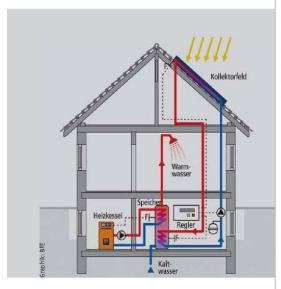
mit Wärmedämmung: Dann kann die Leitung von den Solarkollektoren hinunter in den Keller hinter die Fassade verlegt werden.
