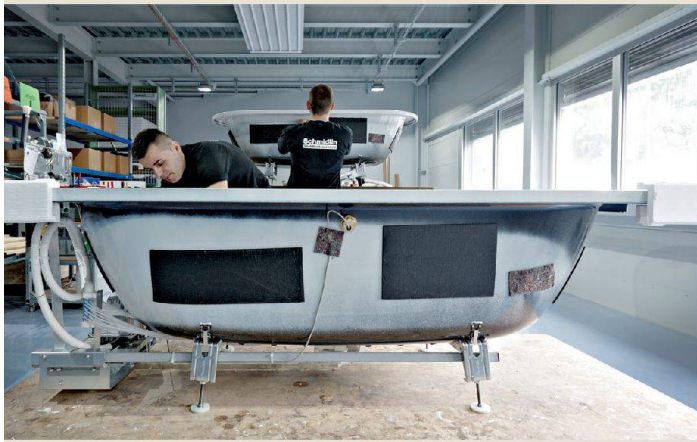
Bei der Endmontage werden die bereits mit Entdröhnplatten bestückten Wannen zu installationsbereiten Whirlwannen ergänzt.
