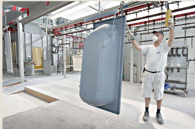
Umhängen einer Wanne vor dem Einbrennen bei 850 Grad im Emaillofen.
