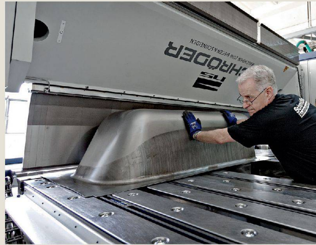
Trotz moderner Anlagen muss für verschiedene Arbeiten Hand angelegt werden, wie hier beim Schneiden einer Spezialwanne.
