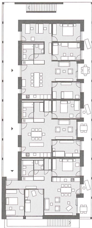
Grundriss erstes Obergeschoss.
