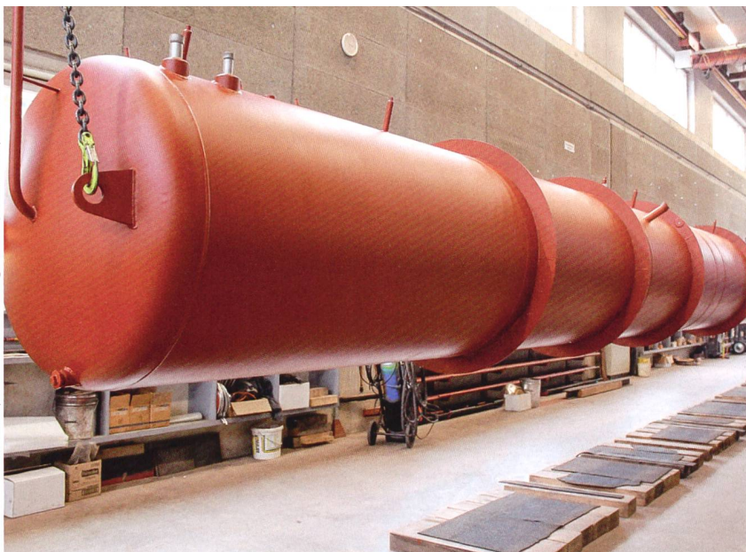
Das «Sonnenhaus» des Architekten Beat Kämpfen in Zürich Schwamendingen verfügt über PV-Anlagen auf dem Dach und thermische Kollektoren an den Fassaden. Die solar erzeugte Wärme wird in riesigen Tanks gespeichert. Der Versorgungsgrad solcher Häuser beträgt 70 bis 100 Prozent.
