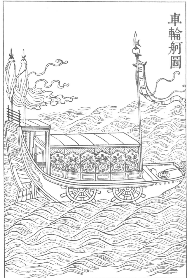
Kriegsdschunken aus dem 11.–12. Jahrhundert wurden durch Tretmühlen und Schaufelräder angetrieben, um von Wind und Flußströmung unabhängig zu sein
