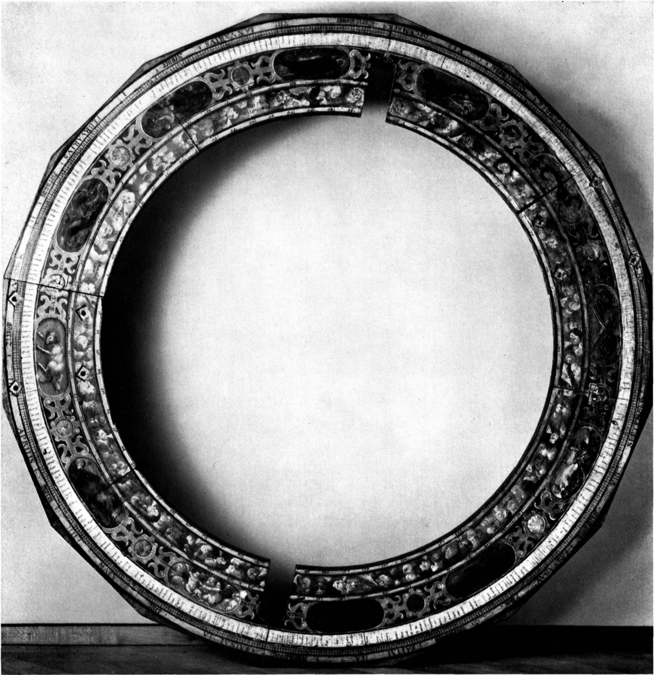
Korbrand des sog. St.-Galler Globus im Schweizerischen Landesmuseum (vgl. Tafel 33) in demontiertem Zustand: Die beiden rechteckigen Aussparungen dienen als Führung des Vertikalkreises. Die Bemalung zeigt neben ornamentalem Schmuck eine Kalenderskala sowie einen Tierzeichenkreis.
