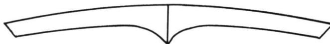
Abb. 5 Schnitt durch die Decke des Bassetts (vgl. Abb. 1): Verstärkung der Mittelfuge (vgl. Abb. 6).
